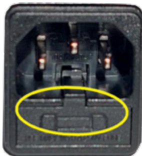
Fig. 43 - Hublot avec les fusibles à enlever
