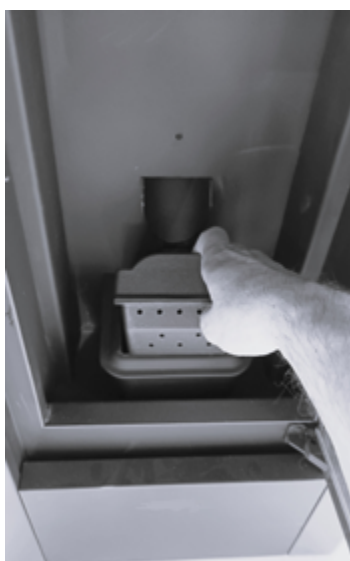
Fig. 30 - Extraction de le brasero
