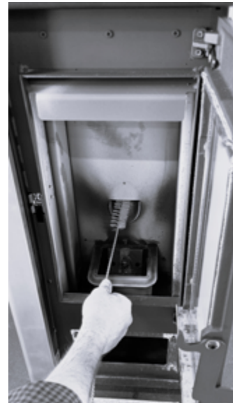
Fig. 33 - Nettoyage avec nettoie-pipes
