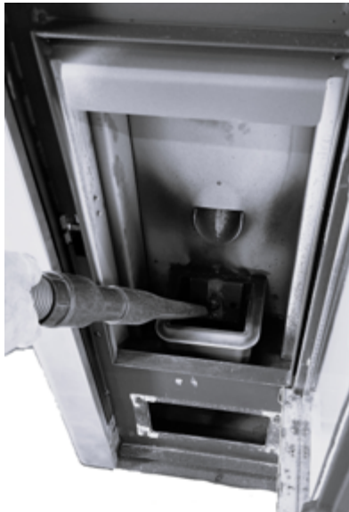
Fig. 32 - Nettoyage l'espace du brasero
