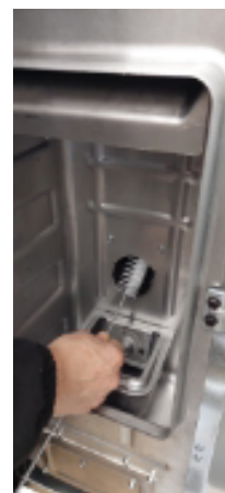
Fig. 36 - Nettoyage avec nettoie-pipes
