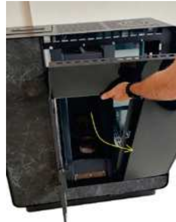
Fig. 40 - Retirer le cadre
