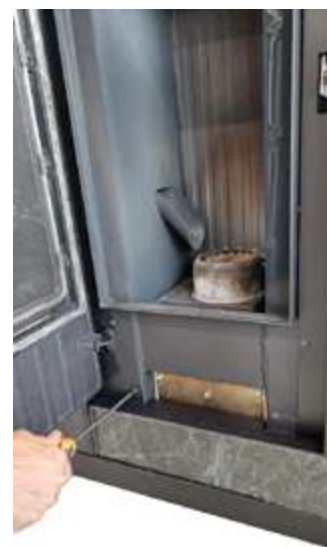
Fig. 70 - Retirez le masque ARCO
