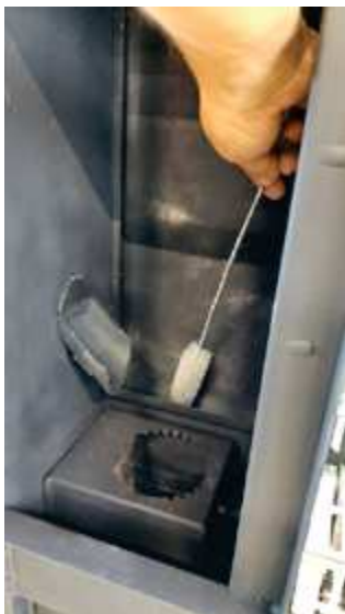
Fig. 78 - Nettoyer avec un goupillon
