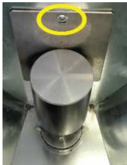
Fig. 84 - Retrait des vis
