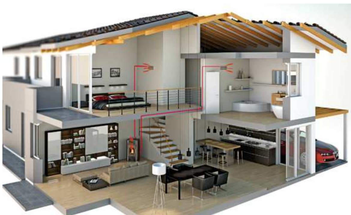
Fig. 62 - Exemple de canalisation
