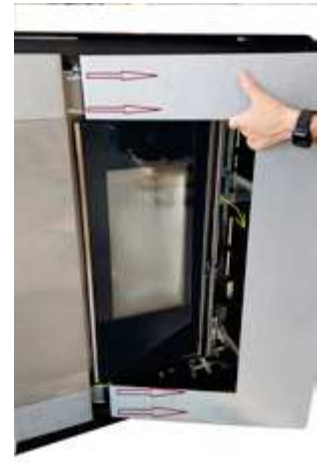
Fig. 43 - Retirer le cadre
