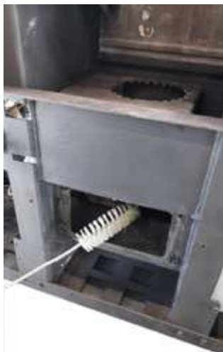
Fig. 72 - Nettoyer avec un goupillon
