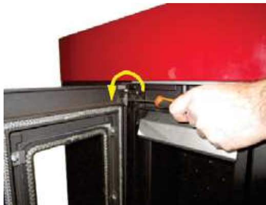
Fig. 44 - Retrait des vis
