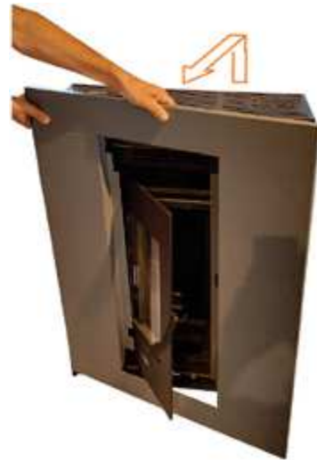
Fig. 29 - Retirer le cadre
