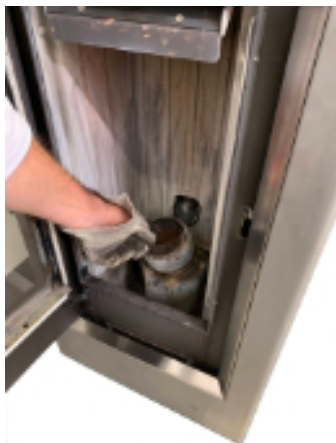
Fig. 31 - Extraction de le brasero
