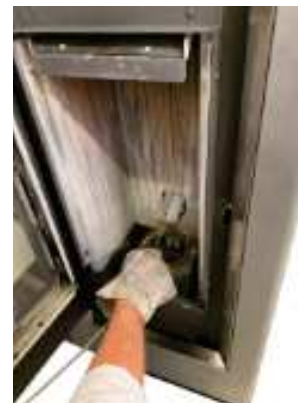
Fig. 37 - Nettoyage avec nettoie-pipes
