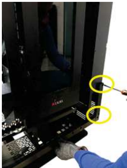
Fig. 50 - Fixation de l'étrier inférieur
