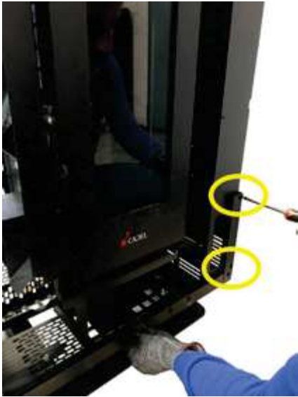
Fig. 43 - Fixation de l'étrier inférieur
