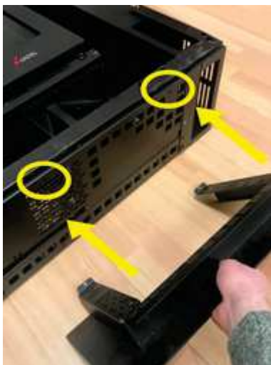
Fig. 82 - Mettre le piédestal en place
