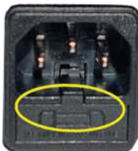
Fig. 105 - Hublot avec les fusibles à enlever
