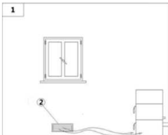
Fig. 8 - Entrée d'air directe
