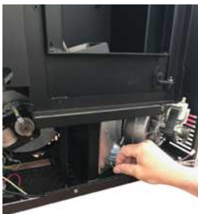
Fig. 97 - Retirer le bouchon d'inspection
