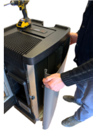
Fig. 39 - Retirer le flanc
