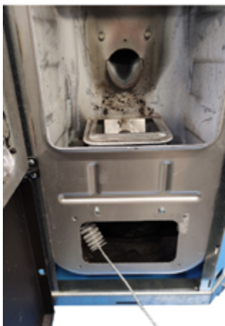
Fig. 91 - Nettoyer avec un goupillon.
