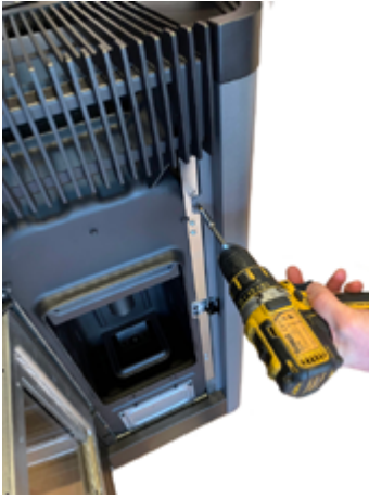
Fig. 37 - Retirer les vis antérieures
