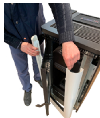
Fig. 43 - Décrocher le cadre
