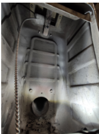
Fig. 93 - Nettoyer avec un goupillon.
