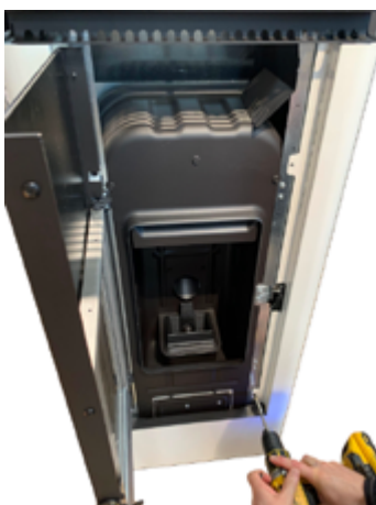
Fig. 42 - Retirer les vis antérieures
