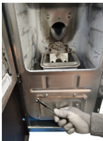
Fig. 89 - Retirer les vis
