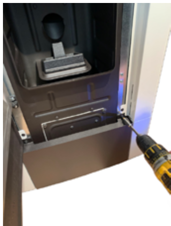
Fig. 44 - Retirer les vis
