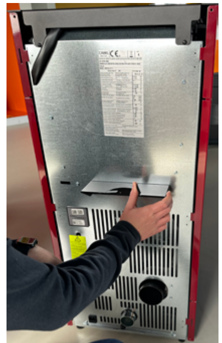
Fig. 64 - Repliez les ailettes
