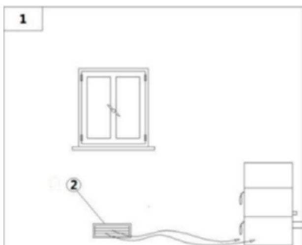
Fig. 8 - Entrée d'air directe
