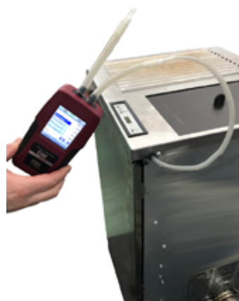
Fig. 87 - Connexion du pressostat numérique
