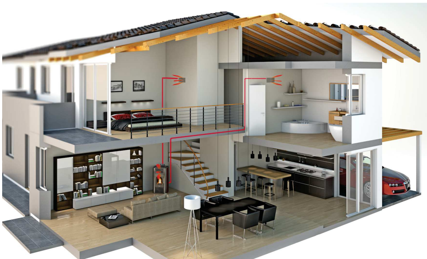
Fig. 85 - Exemple de canalisation
