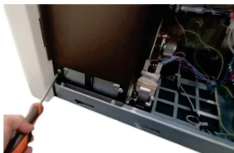
Fig. 109 - Nettoyage de le ventilateur ambiant
