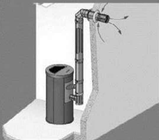
Fig. 17 - Schéma de principe du système concentrique avec terminal horizontal (ZONE 3)
