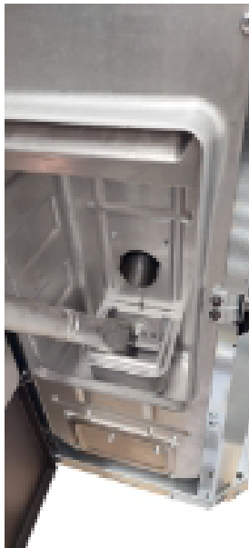
Fig. 19 - Nettoyage l'espace du brasero
