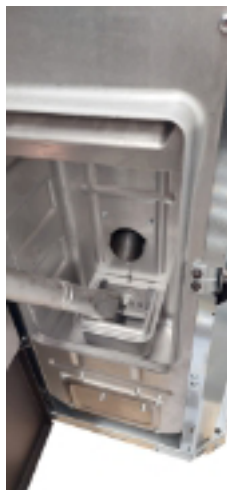
Fig. 35 - Nettoyage l'espace du brasero
