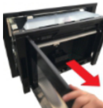
Fig. 27 - Extraction du corps machine
