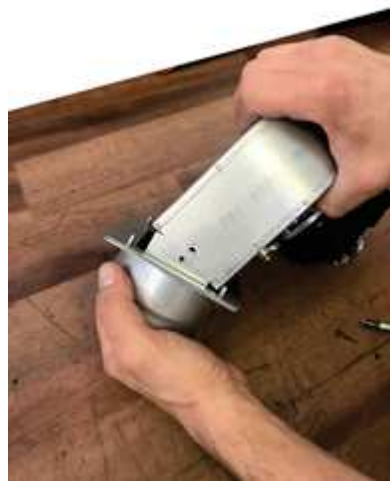
Fig. 39 - Fixer la bride + le raccord au ventilateur
