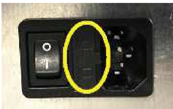
Fig. 81 - Hublot avec les fusibles à enlever
