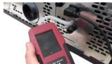
Fig. 60 - Connexion du pressostat numérique Modo At et Quasimodo 3 Up
