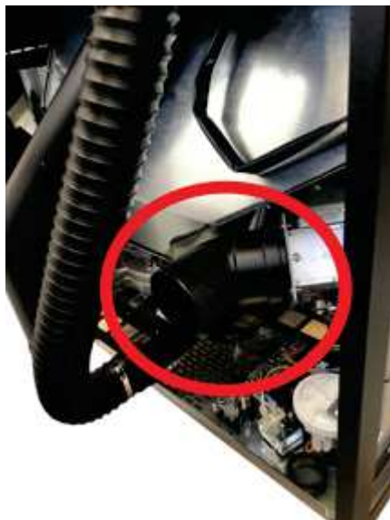
Fig. 45 - Placer le raccord à 45°
