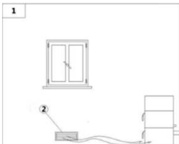
Fig. 8 - Entrée d'air directe
