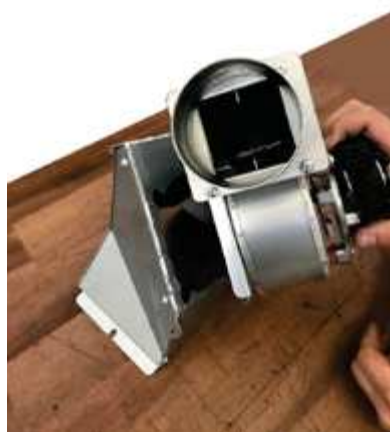
Fig. 42 - Fixer le ventilateur au carter
