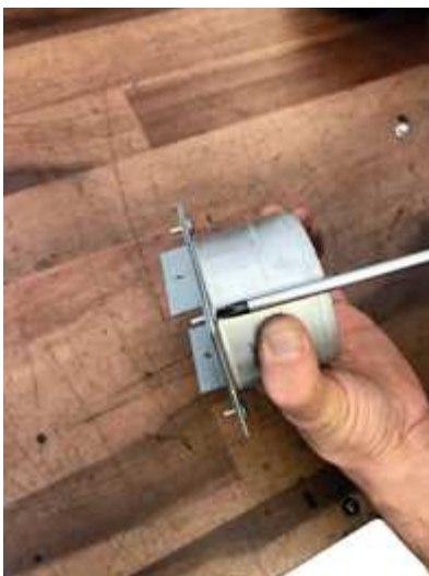
Fig. 38 - Fixer la bride au raccord
