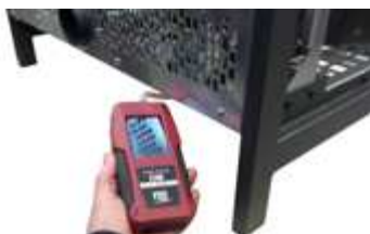
Fig. 59 - Connexion du pressostat numérique Frame 3
