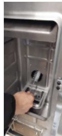
Fig. 38 - Nettoyage avec nettoie-pipes
