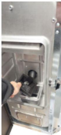
Fig. 35 - Extraction de le brasero
