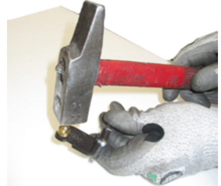
Fig. 25 - Insérer le goujon au contraire
