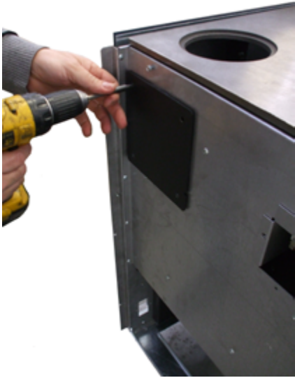
Fig. 47 - Retrait du bouchon
