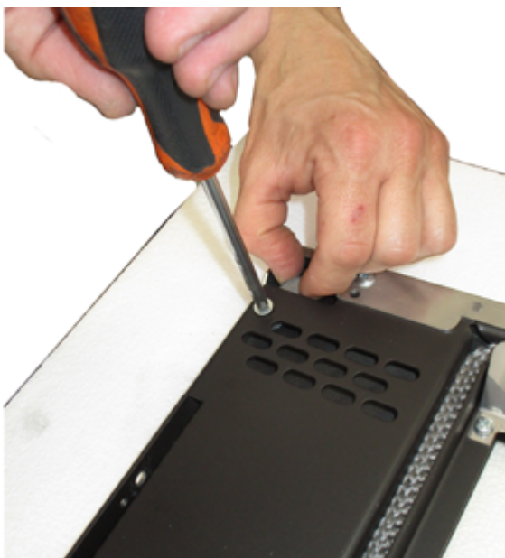
Fig. 34 - Fixer le goujon de blocage de la porte
