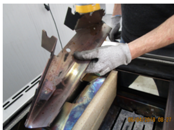
Fig. 64 - Retirer le profil
