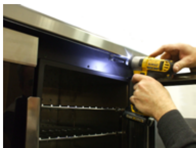
Fig. 70 - Retrait des vis
