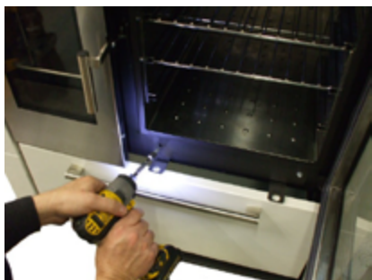
Fig. 53 - Retirer les vis
