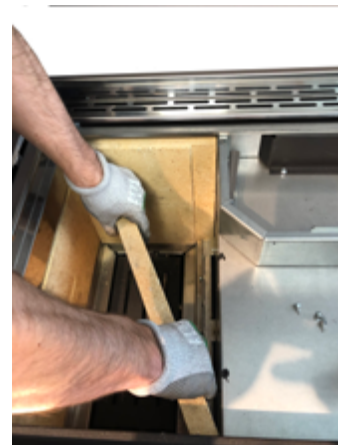
Fig. 67 - Retirer le matériau réfractaire 1
