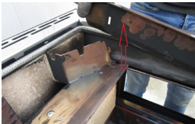
Fig. 61 - Retirer le profil avant
