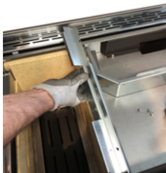
Fig. 66 - Retirer le profil
