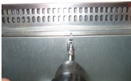
Fig. 20 - Ôter/desserrer les vis
