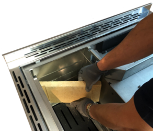
Fig. 68 - Retirer le matériau réfractaire 2
