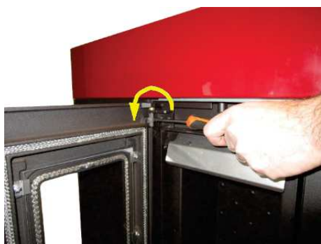
Fig. 28 - Retrait des vis
