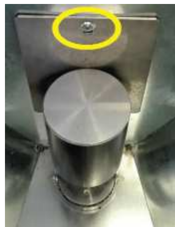
Fig. 98 - Retrait des vis
