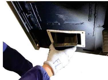
Fig. 88 - Ôter le déviateur de fumées
