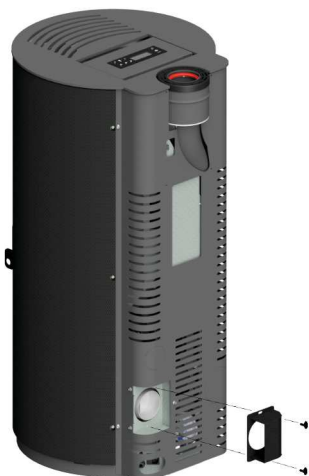
Fig. 54 - Retirer le déflecteur
