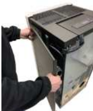
Fig. 45 - Décrocher les flancs
