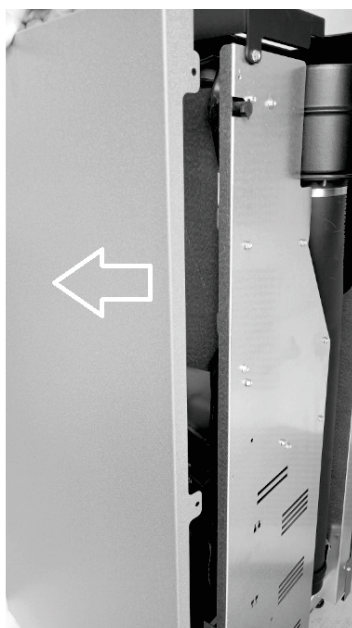
Fig. 48 - Décrocher les flancs
