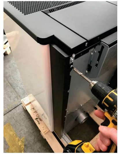
Fig. 55 - Fixer le flanc complet
