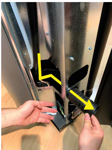
Fig. 74 - Passage du tuyau flexible 1
