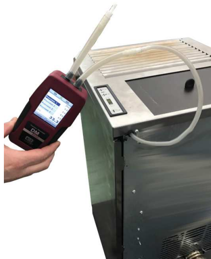
Fig. 82 - Connexion du pressostat numérique 1
