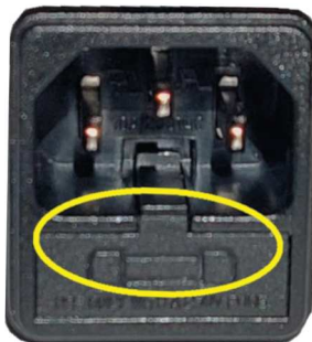
Fig. 95 - Hublot avec les fusibles à enlever
