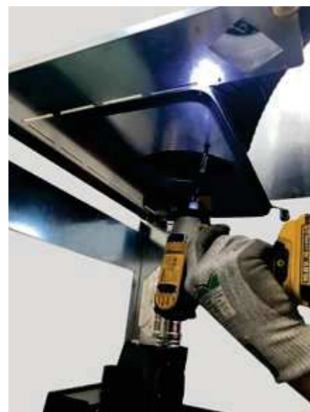
Fig. 78 - Fixation du tuyau flexible
