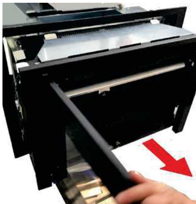
Fig. 29 - Extraction du corps machine
