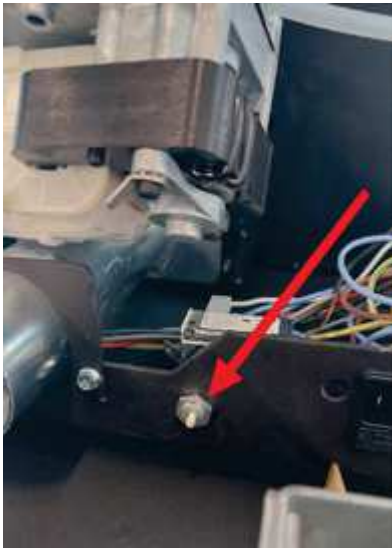
Fig. 40 - Réarmement manuel: il se trouve derrière le réservoir, près de la prise d'alimentation
