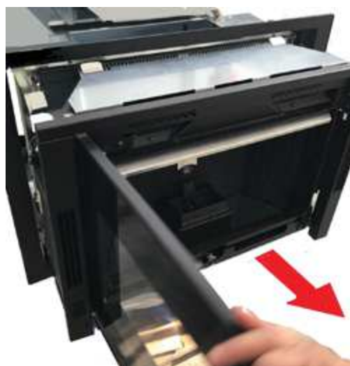
Fig. 25 - Extraction du corps machine
